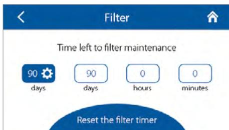
Nastavenie časovača údržby filtra: po uplynutí vopred nastaveného časového obdobia (70–365 dní) sa na hlavnej stránke zobrazí upozornenie na výmenu filtra. **Budíky** zobrazí príslušné informácie o potrebnej výmene filtra. Ak chcete vypnúť časovač filtra (napr. ak je jednotka vybavená tlakovými spínačmi), nastavte hodnotu na 0 dní.
