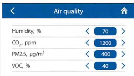
Nastavte prahové hodnoty pre senzory vlhkosti, CO<sub>2</sub>, PM<sub>2.5</sub> a VOC. Jednotka bude automaticky udržiavať užívateľské hodnoty plynulým zvyšovaním alebo znižovaním rýchlosti ventilátora.
